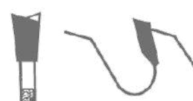
Dientes ATB bisel superior alterno
